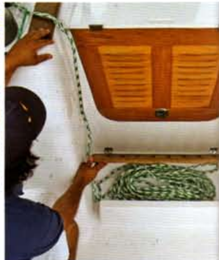
Acima, muito prática a solução da porta de acesso dobrável, que rebate sobre a cobertura móvel e desliza junto, para dentro; e sob o piso, na entrada, prático paiol para os cabos.
