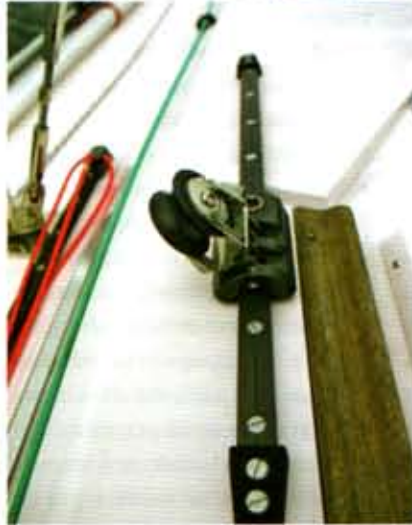
Trilho e carrinho de BB para regulagem da genoa e o único ponto desconfortável que apontamos: posicionamento da manete.
