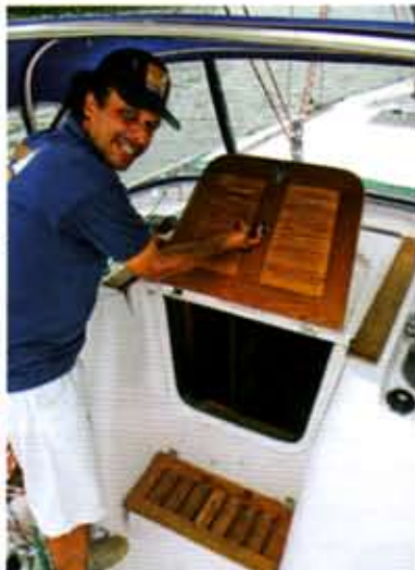
Acima, muito prática a solução da porta de acesso dobrável, que rebate sobre a cobertura móvel e desliza junto, para dentro; e sob o piso, na entrada, prático paiol para os cabos.
